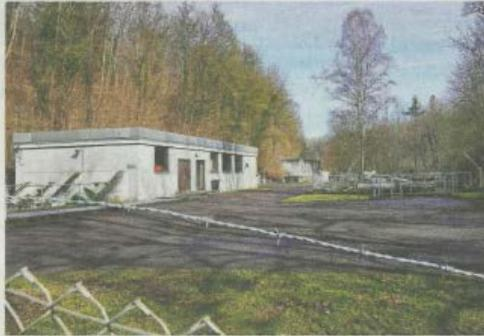
Die Kläranlage in Westheim verfügt über eine Anlage zum Pressen des Klärschlammes. Das Endprodukt enthält bis zu 85 Prozent Wasser und wird im Landschaftsbau verwertet. *Foto: Beatrice Schnelle*
